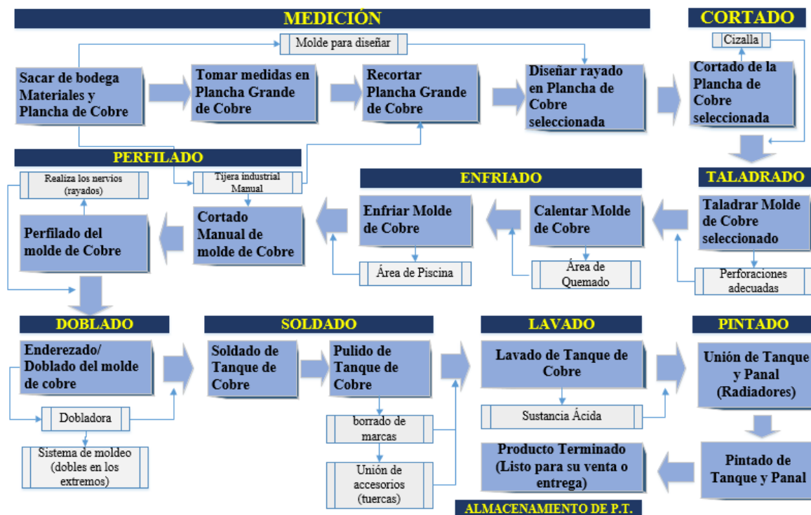
Figura 26. Diagrama de bloques del proceso general. Información adaptada de la empresa Radiadores ALW. Elaborado por el autor.
